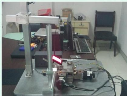
这些类型均属于表面缺陷检测，主要采用对表面进行二值化、平滑、边缘检测、图像标记等对工件表面图像进行处理后，对表面的缺陷进行检测和标记。特点是能够将不同类型的表面缺陷采用不同的标记色来进行标记，便于区分。
