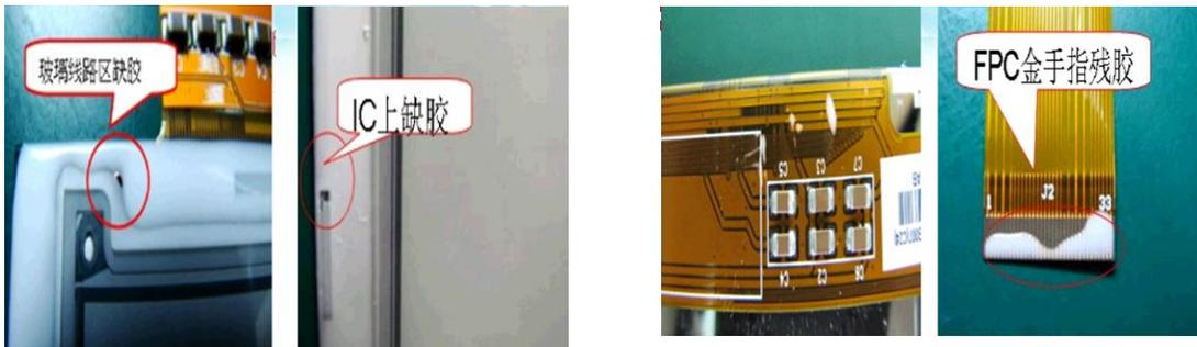
根据实际检查的要求，有必要对各部分单独分析。按照不良现象所处的位置和处理方法的类似性，对可能产生缺陷的部分进行检查。在使用光学镜头检测的情况下，对所检测面的待检测部位有较清楚的聚焦；另外如果所检测的不良现象的样本的颜色或者形状（因为光照等原因），和正规品（良品）原有的颜色形状非常接近，那么检出难度较大，存在不宜区分的情况。
