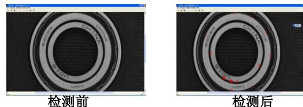
对次品的检出率为100%，不会将任何一个次品误检为正品，对正品的检出率为99.5%，如产品为正品，但相机拍摄的照片有漏针信息，都会误检为次品。
