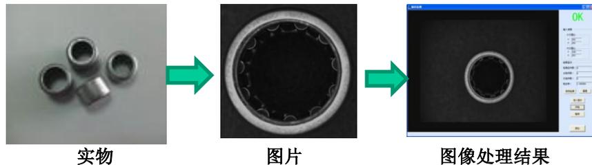
**普通轴承缺陷检测：实现对流水线上即时生产的各种轴承的轮廓缺陷检测、并可以对轴承的批号及商标进行验证。**
