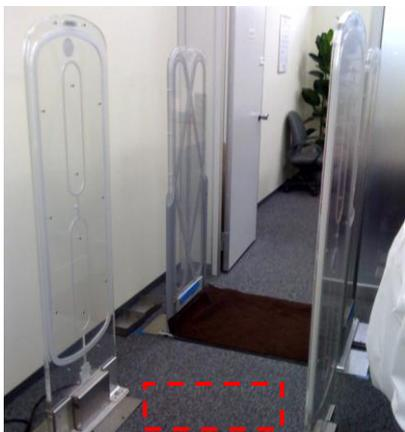
設置イメージは左の写真です。それぞれからコンセントで電源を取るため、ゲート間の配線を無くし、会場の景観を損ないません。(写真はゲート間の幅90m)
